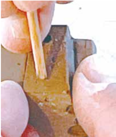
⑤ 正面のライトは丸型(写真はアルミカンナの後ろ面)で深さ1ミリに、背面のテールランプは竹ひごの後ろ面で深さ2ミリ、それぞれ押し当てて装飾する。
